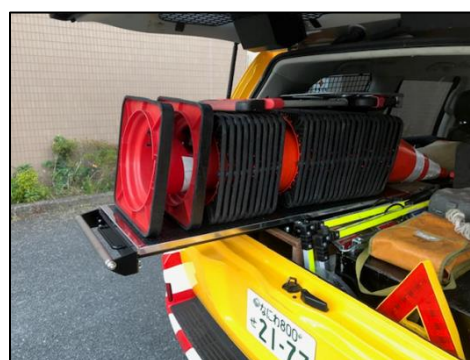
◆写真 D：道路パトロールカー荷室改良（スライド設置）
